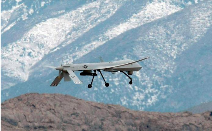
ABBILDUNG1: PREDATOR-DROHNE, STANDARDMÄSSIG MIT ZWEI HELLFIRE-RAKETEN AUSGERÜSTET.
