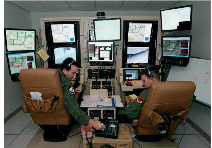
ABBILDUNG 2: KONTROLLSTATION FÜR DIE STEUERUNG EINER REAPER-DROHNE. TAUSENDE VON KILOMETERN VON EINSATZORT DER DROHNE ENTFERNT UND NUR ÜBER SATELLITENKOMMUNIKATION VERBUNDEN.
