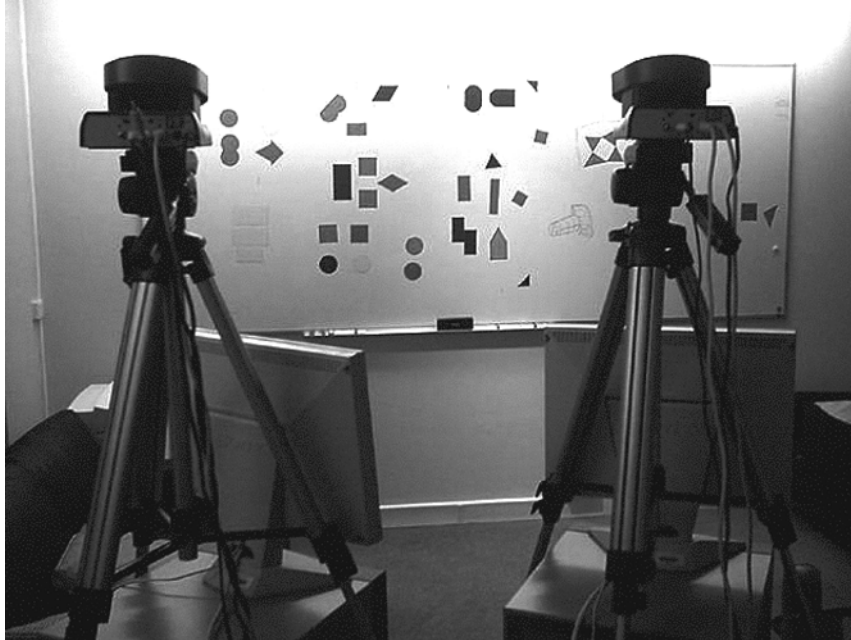
Talking Heads. Zwei steuerbare Kameras, die auf eine Tafel gerichtet sind und sich über das Gesehene in einer gemeinsam entwickelten Sprache austauschen.
